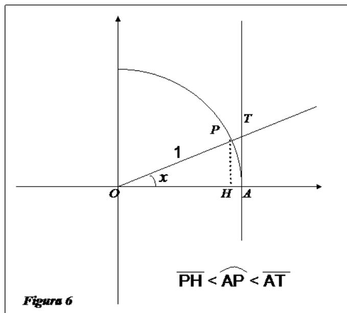
Essendo  $\overline{PH} = \sin x$ ,  $\widehat{AP} = x$  (misurato in radianti) e  $\overline{AT} = \tan x = \frac{\sin x}{\cos x}$  si avrà:
